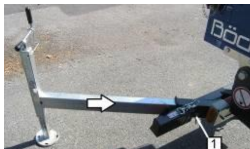
Afb. 37: Achterste steunen plaatsen
