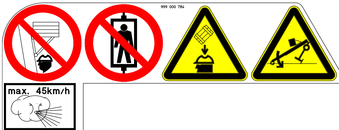
Afb. 1: plaatje - Ga niet onder de last staan, Het transport van personen is verboden, Vallende lasten, Gevaar voor kantelen, Windkracht
